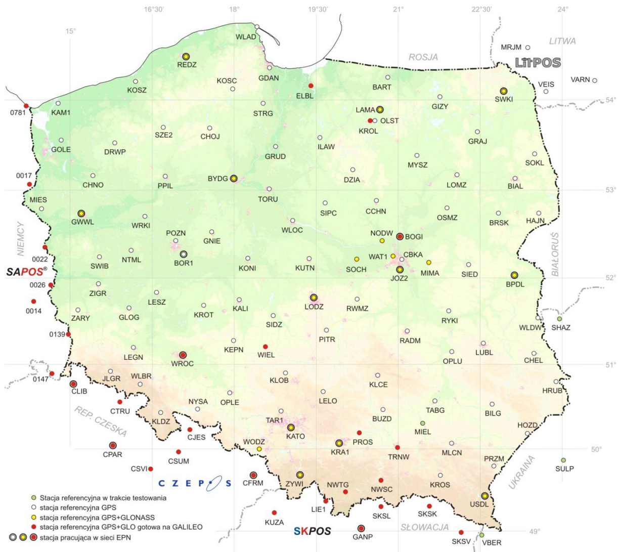
Rys. 6 Rozmieszczenie stacji referencyjnych systemu ASG-EUPOS
